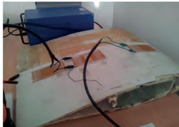
Pruebas de ultrasonidos en pala de aerogenerador para detectar hielo en su superficie
