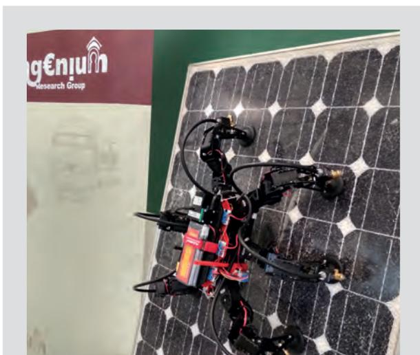
Robot trepador patentado por Ingenium para análisis por END en superficies verticales o de muy gran pendiente
